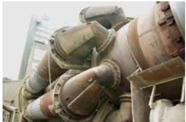
Elle est alors refroidie dans ces gros tubes appelés ballons situés sur les cotés du four, on obtient des boules de ciment, c'est le clinker.
