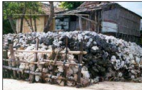
Coquilles servant pour la construction
